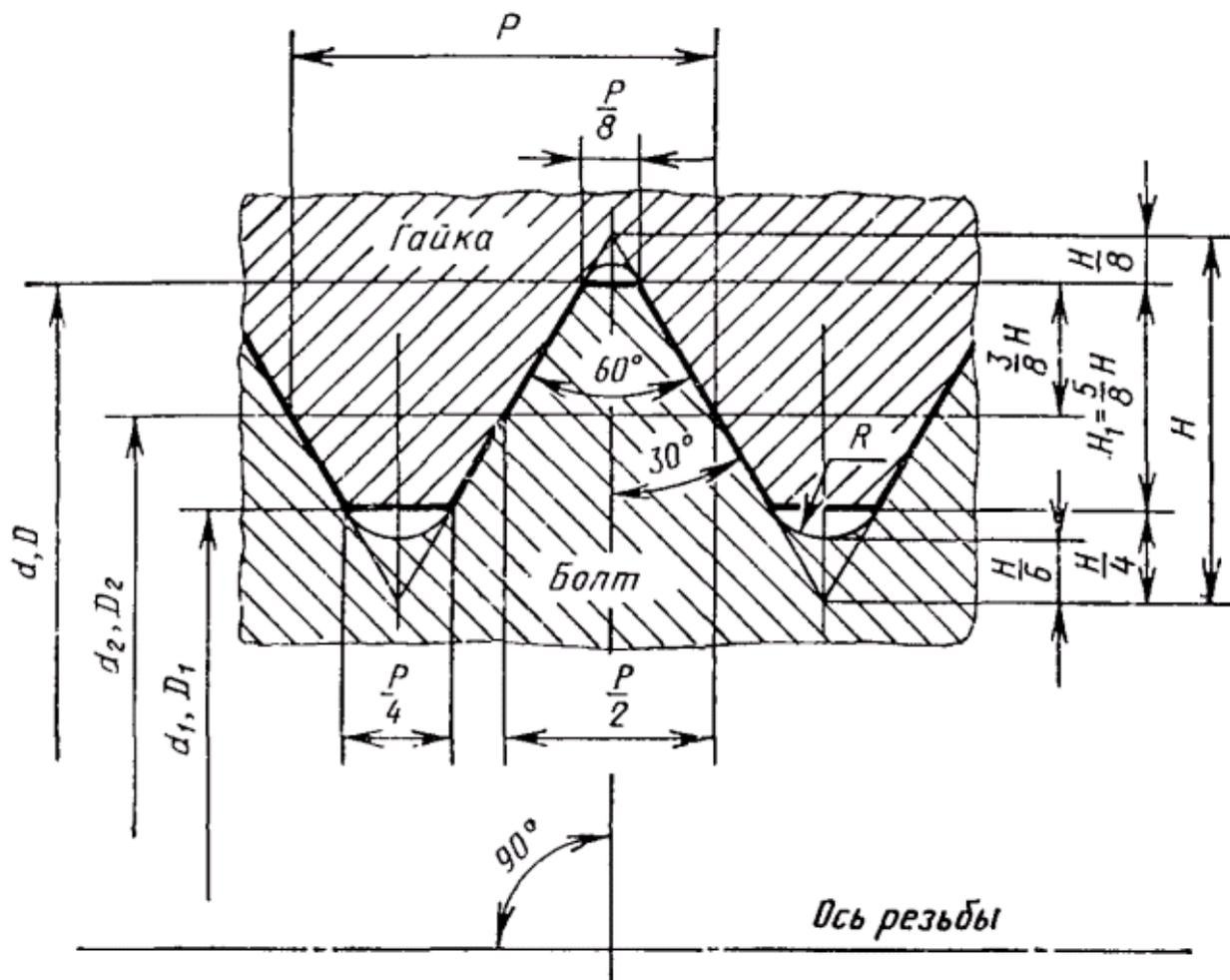
$d$  - наружный диаметр наружной резьбы (болта);  $D$  - наружный диаметр внутренней резьбы (гайки);  $d_2$  - средний диаметр болта;  $D_2$  - средний диаметр гайки;  $d_1$  - внутренний диаметр болта;  $D_1$  - внутренний диаметр гайки;  $P$  - шаг резьбы;  $H$  - высота исходного треугольника;  $R$  - номинальный радиус закругления впадины болта;  $H_1$  - рабочая высота профиля
