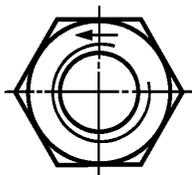
Рисунок 6 — Маркировка левой резьбы
